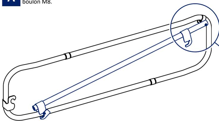
**B** Montez la barre d'accrochage MDS1 du garde-corps, le fil en acier tourné vers l'extérieur. Mettez en place l'entretoise et les rondelles, puis serrez le boulon M8.
