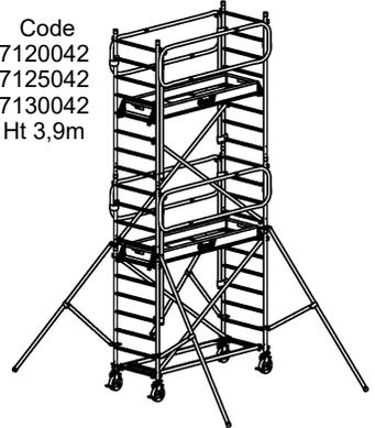
Pour les compositions fournies supérieures à 5,9m et donc sans stabilisateur DS1, il est possible d'utiliser les stabilisateurs DS2 avec 2 échelles de 2m à la place des échelles de 1m pour la hauteur 1,9m
