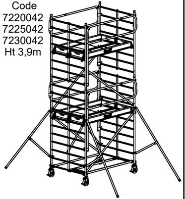
Pour les compositions fournies supérieures à 5,9m et donc sans stabilisateur DS1, il est possible d'utiliser les stabilisateurs DS2 avec 2 échelles de 2m à la place des échelles de 1m pour la hauteur 1,9m
