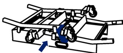
**1** Placer le plancher complet au sol, et détacher la sangle de maintien des piétements.
