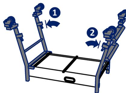
**2** Ouvrir les piétements de support 1 puis de montée 2, jusqu'en butée.
