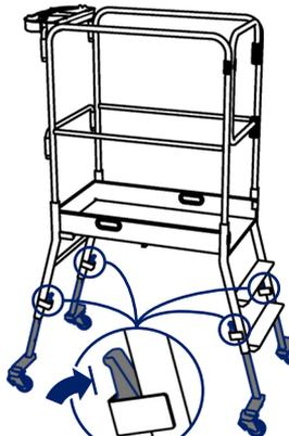
**6** Régler les 4 pieds de la plate-forme à la hauteur souhaitée. La sortie est automatique. Pour rentrer les pieds, appuyer sur les verrous d'un piétement, et accompagner la descente de la plate-forme jusqu'au verrouillage.
