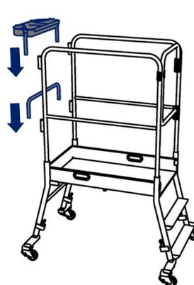
**5** Assembler la tablette et la lisse sur les garde-corps. Ces 2 éléments peuvent être inversés selon le besoin.
