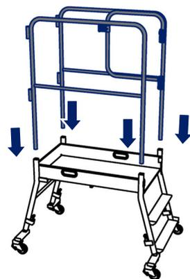
**4** Insérer les garde-corps dans les montants des piétements. Le garde-corps avec portillon se positionne à droite.
