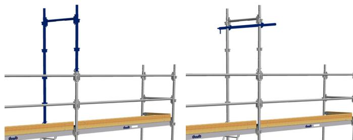
**1** Monter un montant de 2m (50036) côté façade et un montant de 1m (50035) côté rue au-dessus du dernier niveau, à l'emplacement souhaité pour le levage. Relier les 2 montants avec un longeron de 0,83m (50045).
