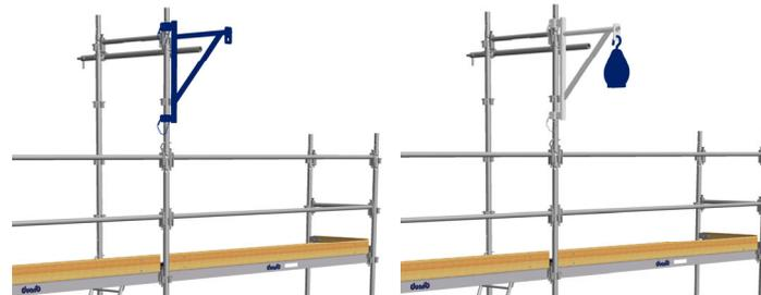
**3** Monter la potence (21710) sur le montant côté rue, et verrouiller à l'aide des goupilles imperdables.
