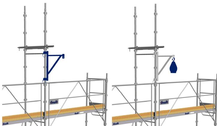
**3** Monter la potence (21710) sur ce cadre, et verrouiller à l'aide des goupilles imperdables.
